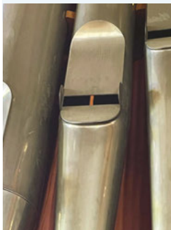
Notdürftig abgestützte Pfeifenöffnung
